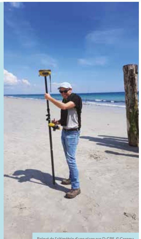
Relevé de l'altimétrie d'une plage par D-GPS. © Cerema
